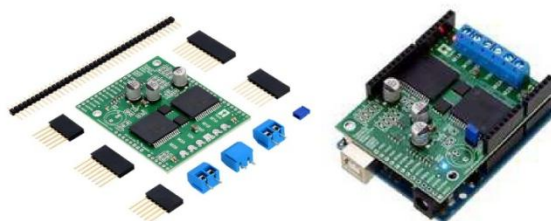
Рис. 10. Плата драйвера двигателя Pololu dual vnh5019: а) в разобранном виде; б) собранная и установленная на Arduino UNO
